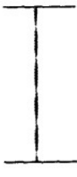
図58 バイアスコップの視野に現れる表面伝播光の像の概念図 (表面応力が強い場合)
