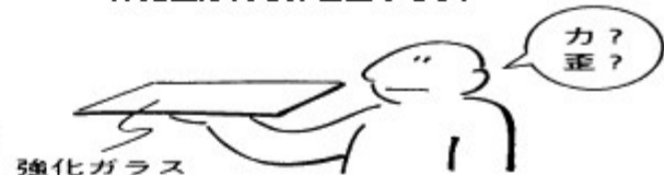
図6a 「歪み」が入っている強化ガラス 外見上は力も弾性歪みもない
