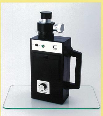
Refractometer-Type Glass Strength Meter LSM-901
