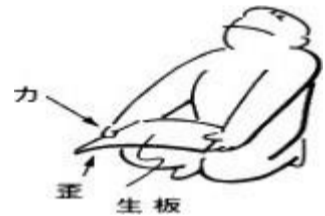
図6b 「歪み」が入っていない生板ガラスに力を加えて弾性歪みを生じさせる
