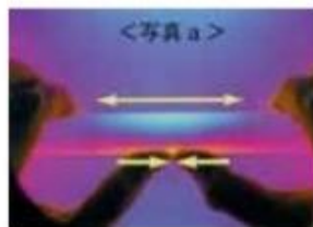
歪がある応力方向確認棒（アクリル）
