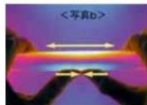
歪がある応力方向確認棒（ガラス）
