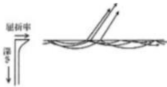
図48 フロートガラスの表面層内を光がモードを作って伝わる状況の説明図
