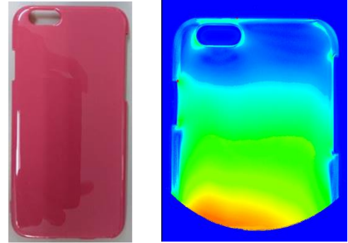
検査方式:近赤外 3 波長直線偏光方式
